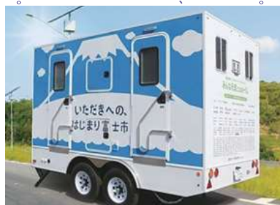
トイレトレーラー（一般社団法人助けあいジャパン東京事務所提供）
