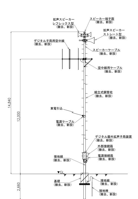
更新局(39局) 屋外拡声スピーカー設置図(単位:mm)
