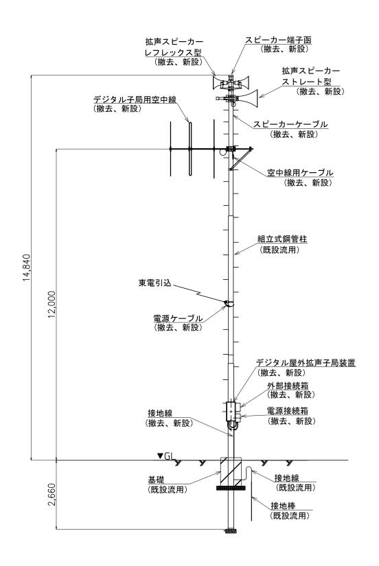
流用局(5局) 屋外拡声スピーカー設置図 (単位:mm)
