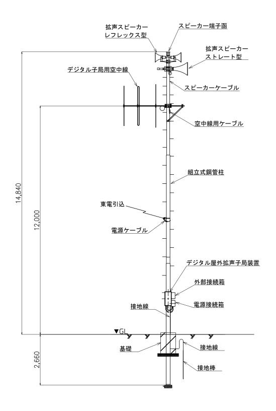
新設局(3局) 屋外拡声スピーカー設置図 (単位:mm)
