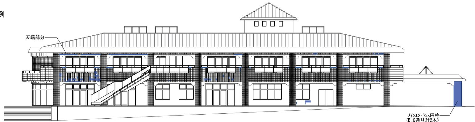
■ タイルの補修箇所（塗装、張替え及び樹脂注入）
