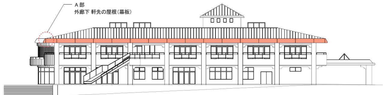
撤去及び新設（L字アングル、アルミパネル及び塗装）
