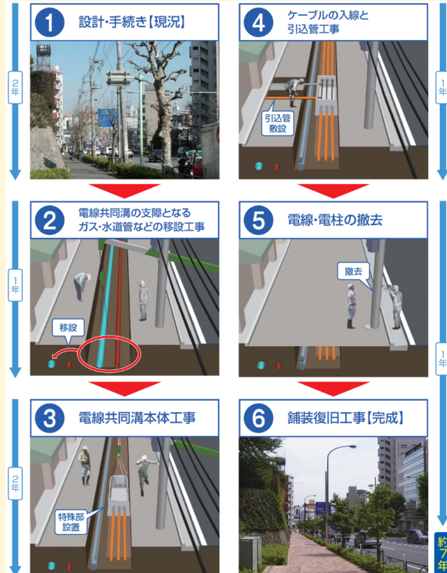
図 電線共同溝の整備の流れ
