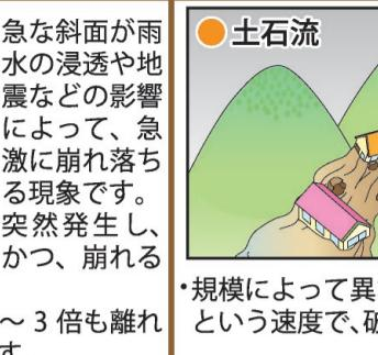
・山腹や川底の土、砂が長雨や集中豪雨などの影響によって、一気に下流へと移動する現象です。斜面の表面部が滑り落ちる表層崩壊と、深層の地盤までが崩れ落ちる深層崩壊があります。
