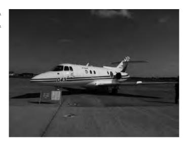
●ブリティッシュ・エアロスペース U-125 ビジネスジェット機BAE125 を転用した機体である。電波により 航空機の航行を支援する「航空保安 無線施設」の動作確認を行うための 自動飛行点検装置を搭載している。
